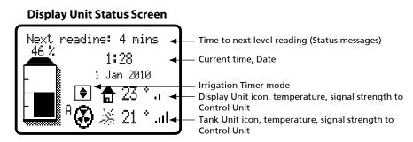
'Ḥ̃' : Auto Mode 'Ḥ̄' : Manual Mode 🌘 : Pump On 🕞 : Irrigation Timer mode off
